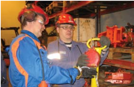
Putoamissuojainten tarkastus ja huolto Pyhäsalmissä.
