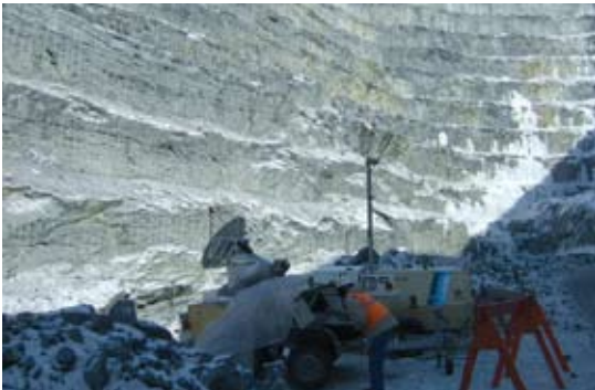
Surveillance constante de la stabilité de la paroi de la fosse de Troilus au cours des derniers mois d'extraction minière. Le radar qui détecte les mouvements avec une précision millimétrique balaie l'ensemble de la paroi de la fosse en huit minutes.
