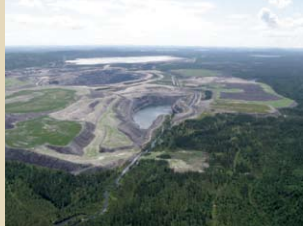
Vue de la fosse en cours d'inondation et de l'implantation progressive du couvert végétal à Troilus de 2007 à 2009.
